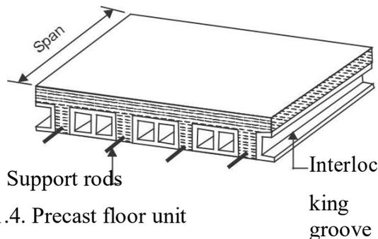
fig. 3.1.4. Precast floor unit
